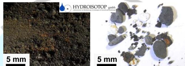
Abbildungen: Oberfläche eines Korrosionscoupons mit Korrosionsbelägen (links) und mineralischer Rückstand aus Filter (rechts)
